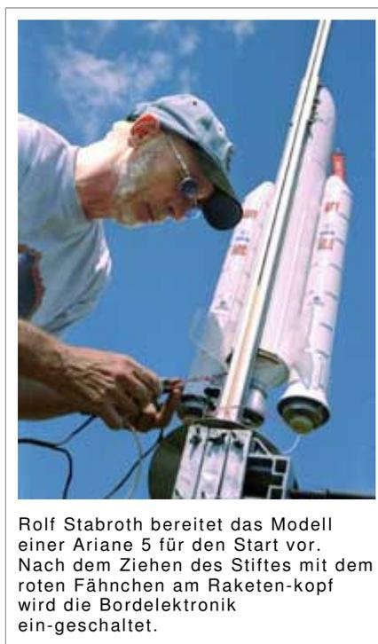
Rolf Stabroth bereitet das Modell einer Ariane 5 für den Start vor. Nach dem Ziehen des Stiftes mit dem roten Fähnchen am Raketen-kopf wird die Bordelektronik ein-geschaltet.
