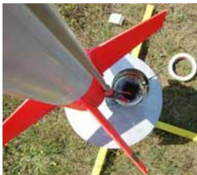
Das Schwarzpulver dient bei diesem Modell als Synchronzündung für ein Bündel von vier Raketenmotoren. Der damit erzeugte Schub ist beeindruckend.
