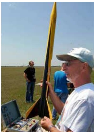
Die von Rolf Stabroth entwickelte "Rocket Countdown Machine" (links unten) löst nach einem akustischen Countdown – wahlweise in verschiedenen Sprachen – automatisch die Zündung für den Raketenstart aus.
