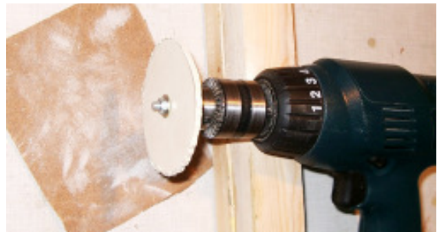
In Akkuschauber einspannen und mit Schmirgelpapier Kanten glätten
